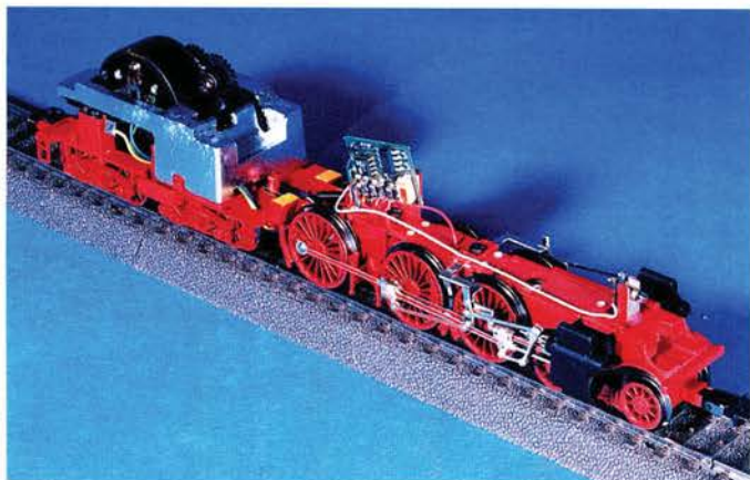
Das Innenleben: Ballastgewicht und Motor mit Schwungmasse befinden sich im Tender, der Uhlenbrock-Lokdecoder ist im Kessel untergebracht.
